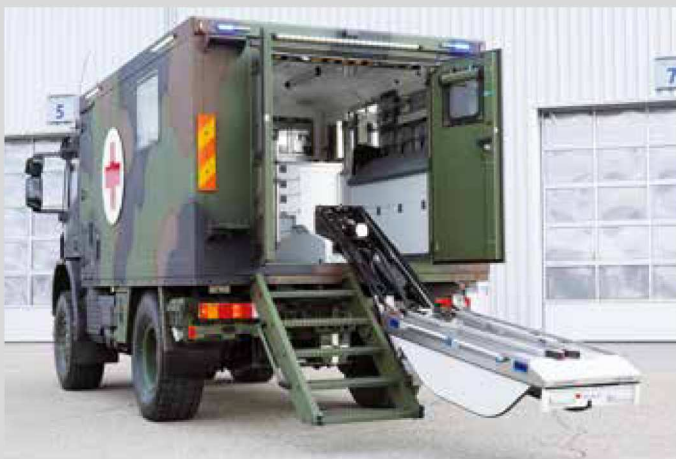
Patienten-Tragentisch mit neuentwickelter Kinematik (Abb.: alle Abbildungen Iveco Magirus AG)
